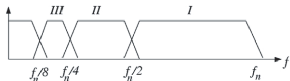
Рис. 2. Иллюстрация изменений частотного диапазона на разных уровнях разрешения при использовании пирамидального алгоритма разложения
